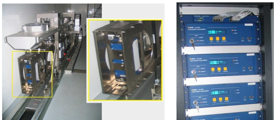
Fot. A.3. Belka pomiarowa z czujnikami laserowymi (po lewej), jednostka kontroli (z prawej)
