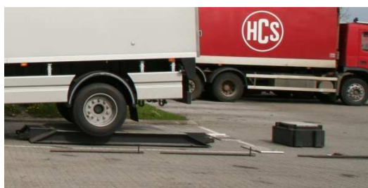
Rysunek A.4. Kalibracja TSD z usunięciem obciążenia (z lewej) oraz schemat kalibracji geometrycznej (z prawej)
