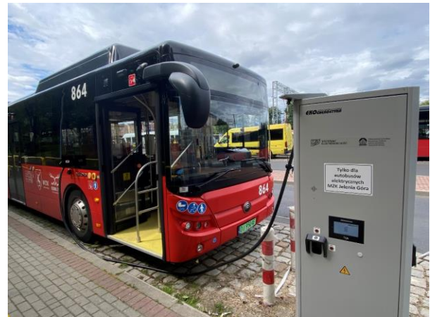
Rys. 4.9 Ładowanie autobusu elektrycznego akumulatorowego MAXI z terenowej ładowarki typu plug-in zlokalizowanej przy dworcu kolejowym w Jeleniej Górze
