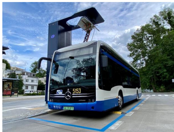
Rys. 7.1 Autobus elektryczny akumulatorowy MAXI na stacji szybkiego ładowania w Gdyni
