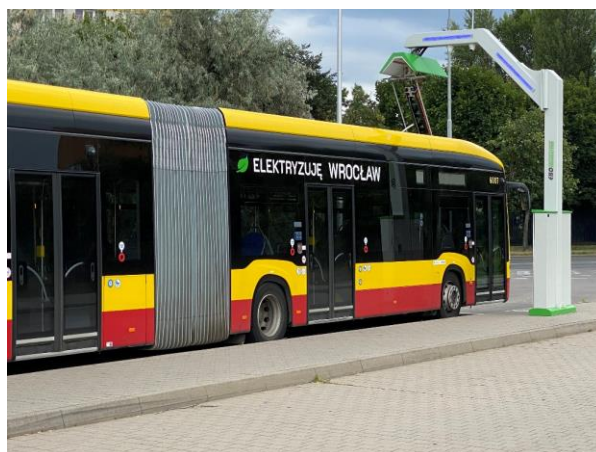
Rys. 4.10 Ładowanie autobusu elektrycznego akumulatorowego MEGA18 z ładowarki pantografowej we Wrocławiu
