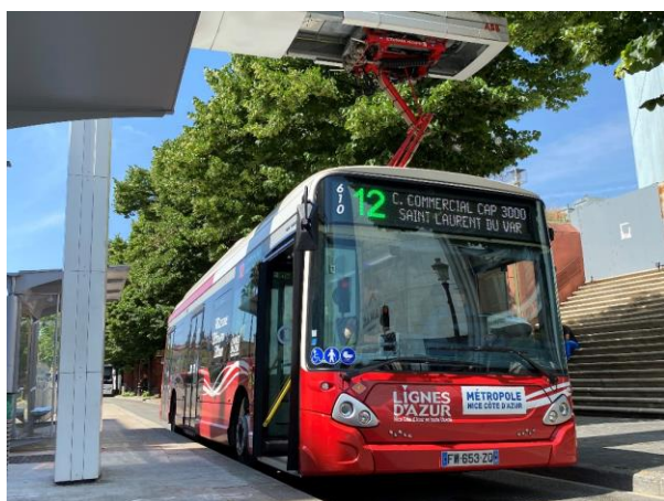
Rys. 4.7 Autobus elektryczny akumulatorowy MAXI podczas szybkiego ładowania, Nicea, Francja
