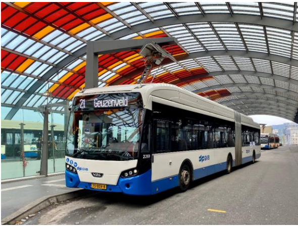
Rys. 1.7 Autobus elektryczny akumulatorowy MEGA18 na stacji szybkiego ładowania w trakcie postoju wyrównawczego w Amsterdamie, Holandia
